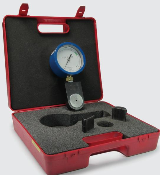
Les dynamomètres et manomètres sont des instruments de mesure précis qui permettent de s'assurer, en quelques minutes seulement, de la conformité de l'effort développé par un outil ou une source hydraulique.
